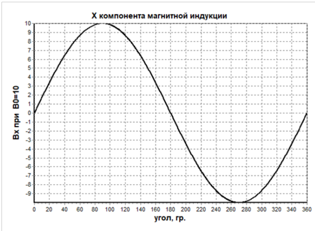
Рис.2. Зависимость X-компонентов магнитной индукции V от угла радиус вектора
