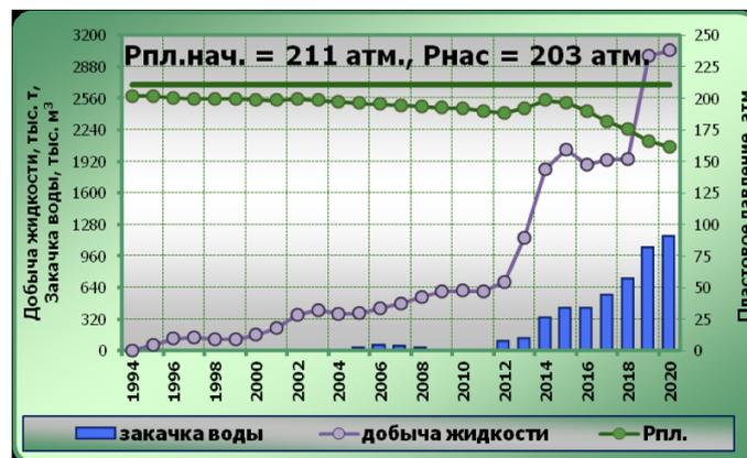
Рис. 1 – Зависимость пластового давления от темпов освоения месторождения
