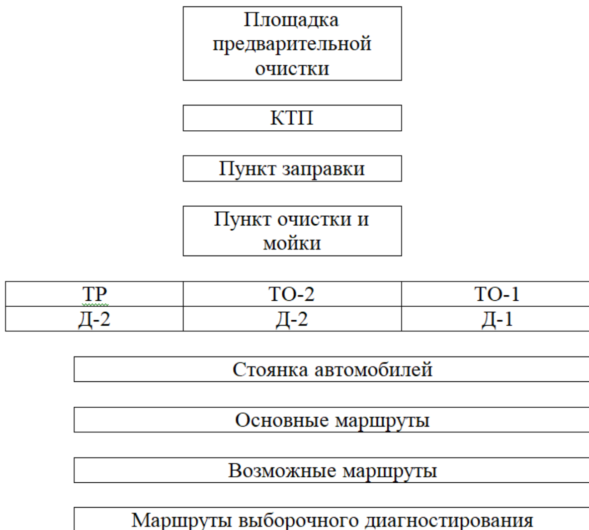
Рисунок 1. Принципиальная схема организации ТО и ТР автомобилей с диагностированием
