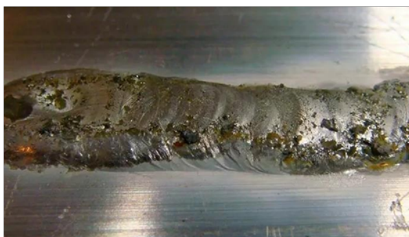
Рисунок 2.3. Шлаковые включения сварного шва
