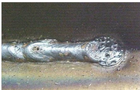
Рисунок 2.2. Поры сварного шва
