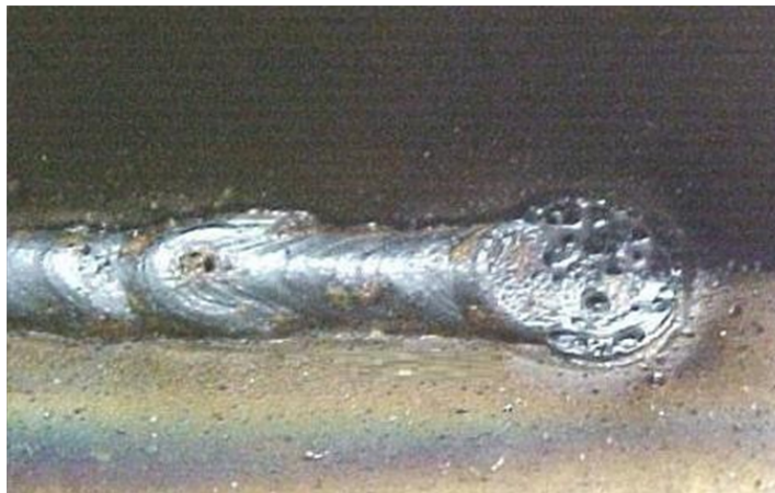
Рисунок 1.2. Пористость в сварном шве
