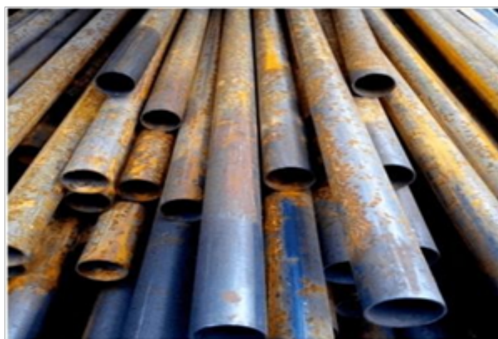
Рисунок 2.5. Поверхностное окисление трубы
