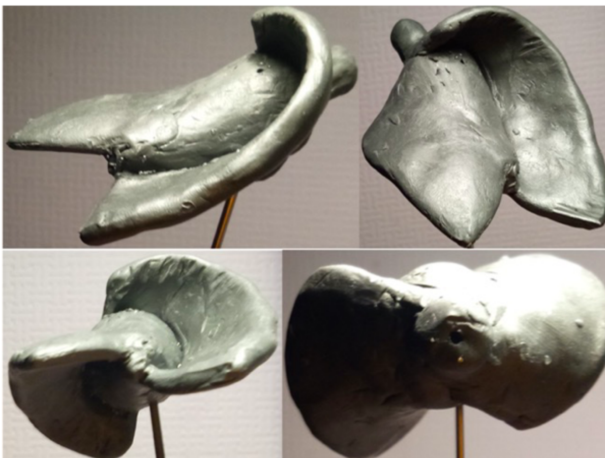
Рис. 13. Конструкция пустотелых вихревых лопастей
