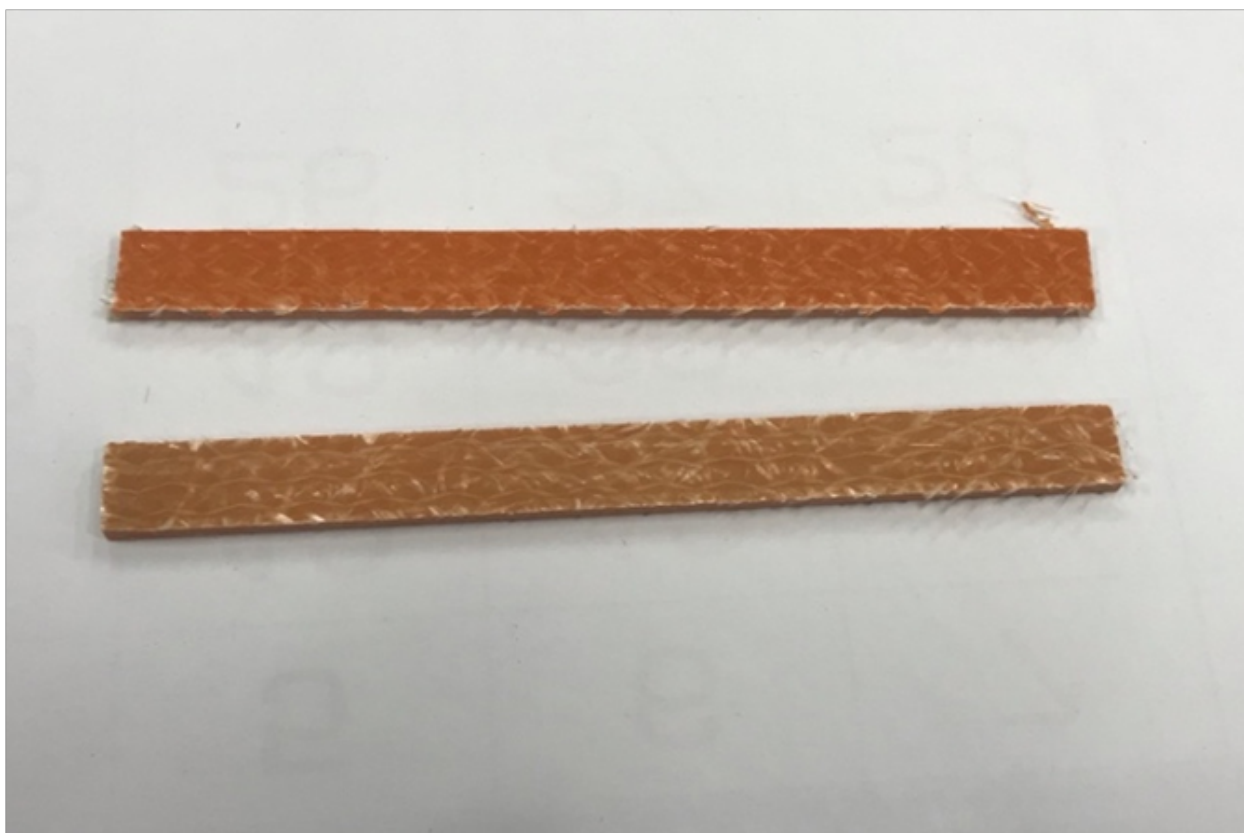
Рис. 3. Внешний вид образцов для испытаний без УФ-облучения (верхний) и с УФ-облучением (нижний)
